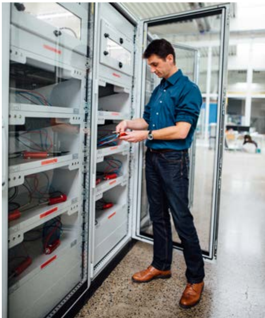
Im Batterietestzentrum werden unter anderem Kurzschluss- und Überladeversuche durchgeführt.
