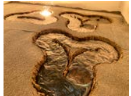
Die Fertigung der Pflasterelemente würde mittels Laser bzw. gebündeltem Sonnenlicht erfolgen.
